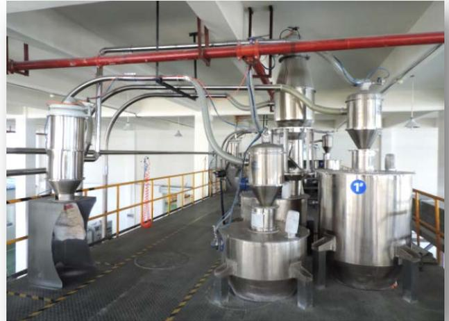
真空输送的优点是真空泵产生向内吸引力并减少了粉尘泄露。因此真空系统被用于需要高洁净或粉尘控制的环境。
