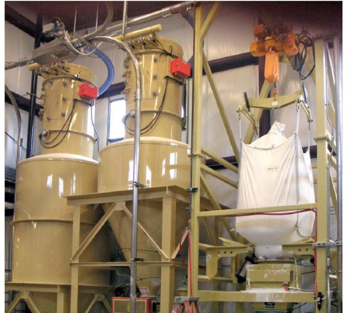
连续真空系统：通过连续式真空上料机将吨包卸料站中的TiO<sub>2</sub>送入计量料斗。
